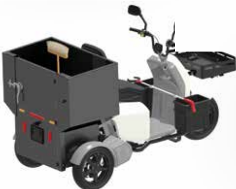
„Kommunal Spezial“ für Parks in Frankreich. Zwei kleine Müllsampler vorne beim Fahrer, inklusive Greifzange: So lässt sich Zeit sparen. Und im Container ist viel Platz, zum Beispiel eine 240-l-Mülltonne.
