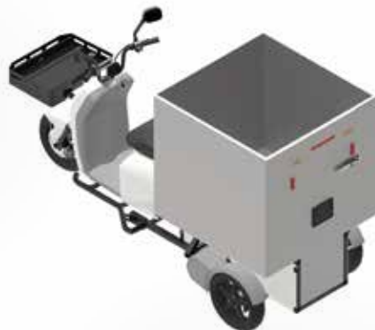
„Kommunal Spezial“ für Parks in Frankreich. Zwei kleine Müllsampler vorne beim Fahrer, inklusive Greifzange: So lässt sich Zeit sparen. Und im Container ist viel Platz, zum Beispiel eine 240-l-Mülltonne.
