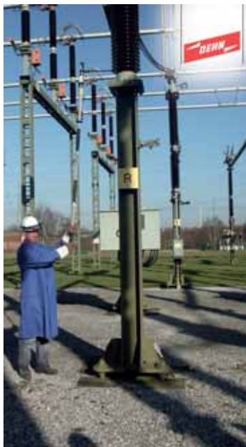
Eine optische und akustische Anzeige auf dem Gerät signalisiert, ob Spannung vorhanden ist oder nicht.
