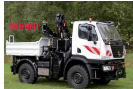
Unimog U20, Aufbau wechselbar: Kran & Kipppritsche für Sommerbetrieb, Pflug & Streuer für Winterdienst.
