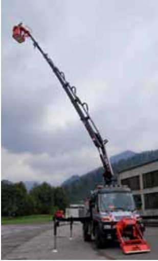
Kran in der 17 mto-Klasse, FMG-Abstützsystem, Hubarbeitskorb und Frontseilwinde. Anwendung für die gehobene Leistungsklasse.
