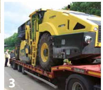
1 Mit seinen vielfältigen Anwendungsmöglichkeiten ist der Recycler/Stabilisierer RS 500 von Bomag eine zuverlässige Maschine für jede Baustelle. 2 Die Seitenverschiebbarkeit des Fräsrotors nach links oder rechts über die Radkante hinaus ermöglicht es, bis in die Randzone einer Fahrbahn zu fräsen. 3 Dank der höhenverstellbaren Kabine des RS 500 ist ein einfacher Transport mittels eines Tiefladers kein Problem.
