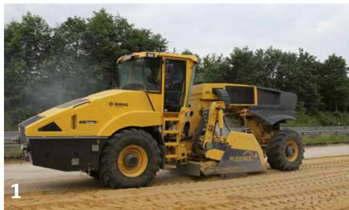
1 Mit seinen vielfältigen Anwendungsmöglichkeiten ist der Recycler/Stabilisierer RS 500 von Bomag eine zuverlässige Maschine für jede Baustelle. 2 Die Seitenverschiebbarkeit des Fräsrotors nach links oder rechts über die Radkante hinaus ermöglicht es, bis in die Randzone einer Fahrbahn zu fräsen. 3 Dank der höhenverstellbaren Kabine des RS 500 ist ein einfacher Transport mittels eines Tiefladers kein Problem.
