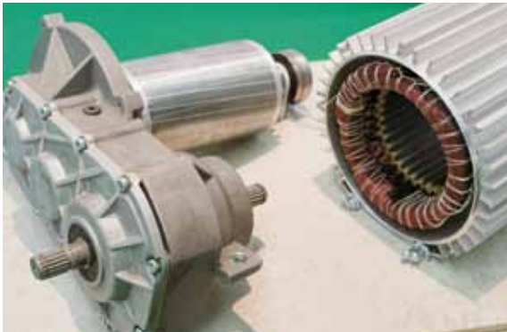
In dem feststehenden Stator (rechts) dreht sich der Rotor (oben mitte). Foto: Bill Lorenz
